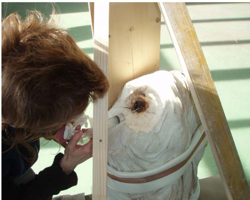
Consolidation de fissures, sur un buste en marbre, par infiltration d'une résine synthétique.
