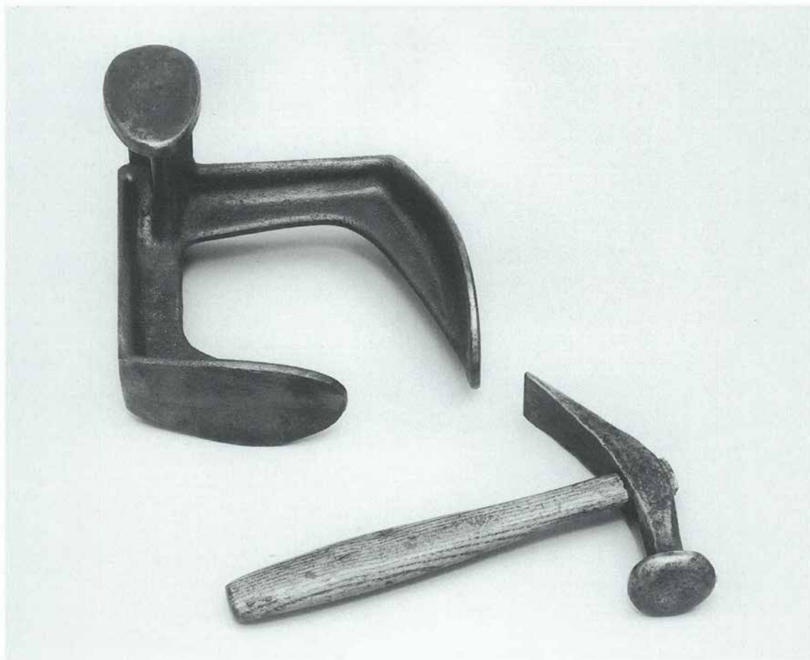
Figure 31. Pied de cordonnier et marteau. Le pied de cordonnier tripode autorisait la mise en service de n'importe laquelle des 3 tables, selon le travail à accomplir, sur la semelle ou le talon. Quant au marteau, il est classique mais très élégant, voire aristocratique avec son fer galbé et sa large pastille débordante. Long. du marteau: 22 cm.
