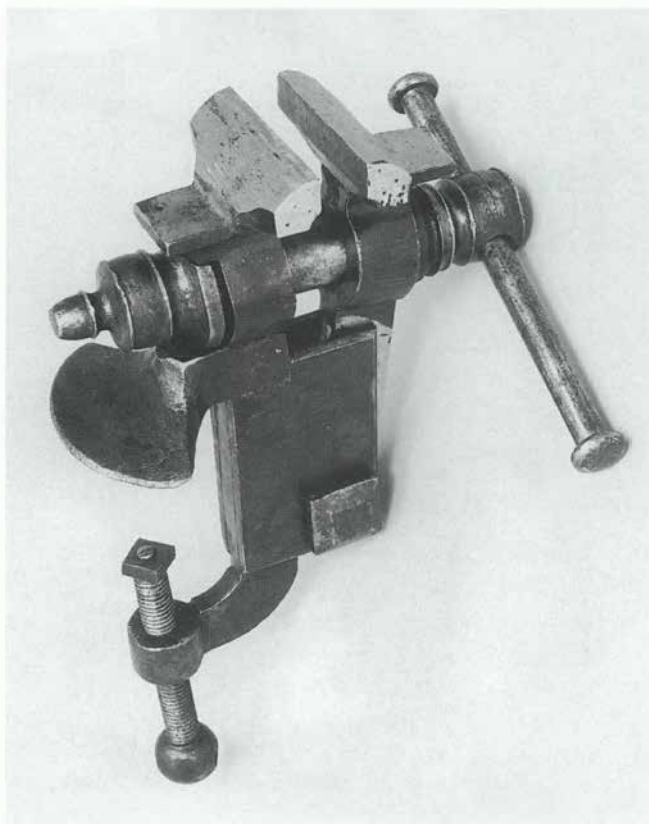
Figure 47. Etai. Peut-être bien que le petit étai parallèle est à considérer comme emblématique du métier de serrurier ou de mécanicien, car rien n'est possible sans cette mâchoire forte qui immobilise le fer à travailler: tige à fileter, barre à scier ou pièce à déformer. Long.: 26,5 cm.
