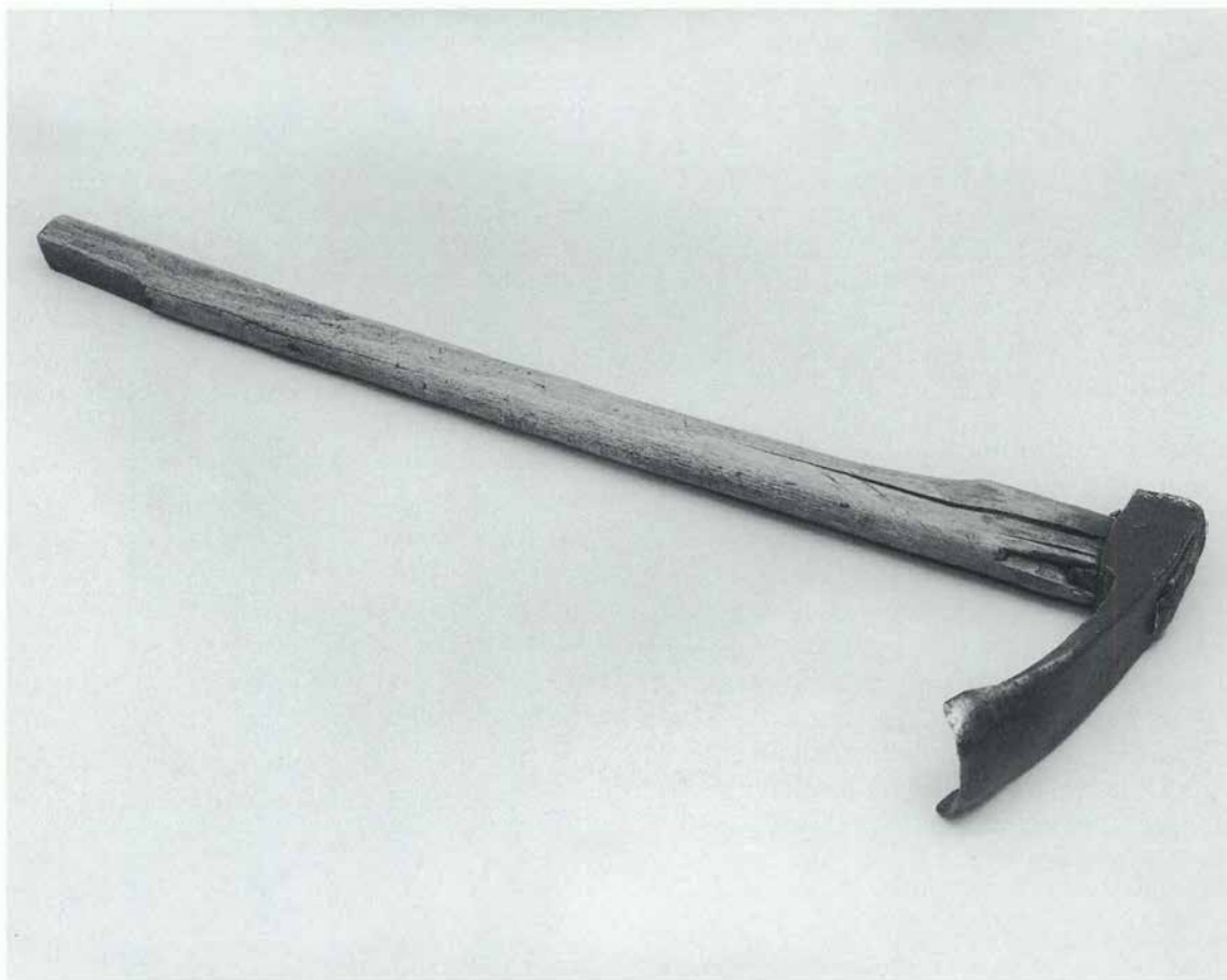
Figure 13. Herminette-gouge. Sorte de pioche à fer coupant et lame creuse que les fontainiers utilisaient pour évider les bassins taillés dans un billon d'épicéa ou de mélèze. Long.: 67 cm.
