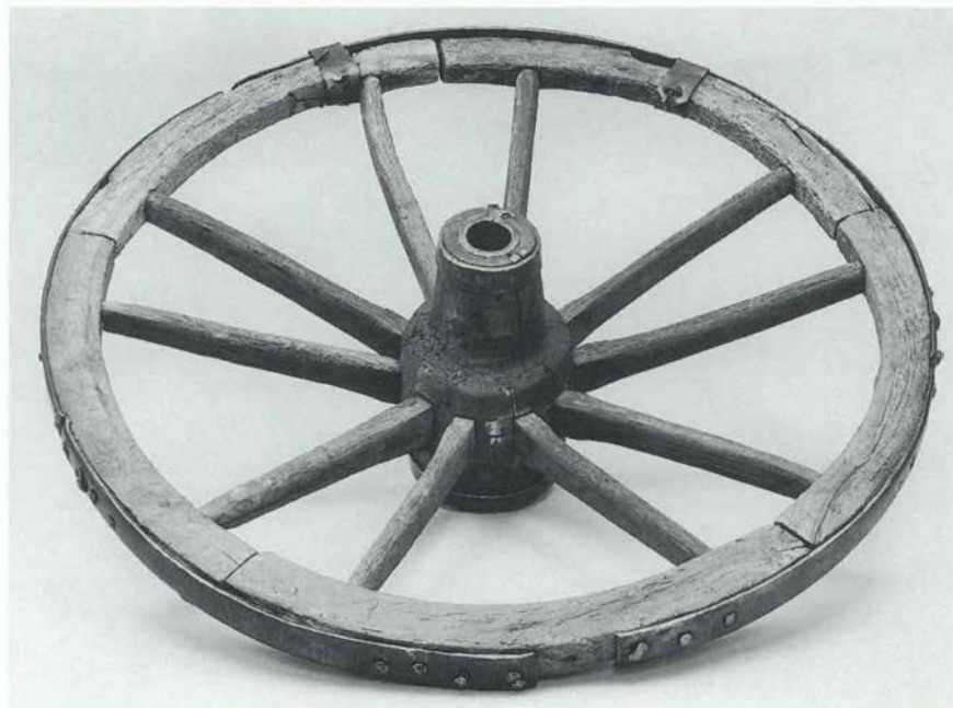
Figure 15. Roue de char. Il y eut sans doute des charrons à la Vallée, puisqu'il y eut des paysans utilisant des chars! Les roues, seuls témoins de ce métier dans la collection, nous paraissent tellement naturelles qu'on ne les remarque pas, alors qu'elles sont pourtant des merveilles d'ajustements savants et de précision. Diam. max.: 92,5 cm.
