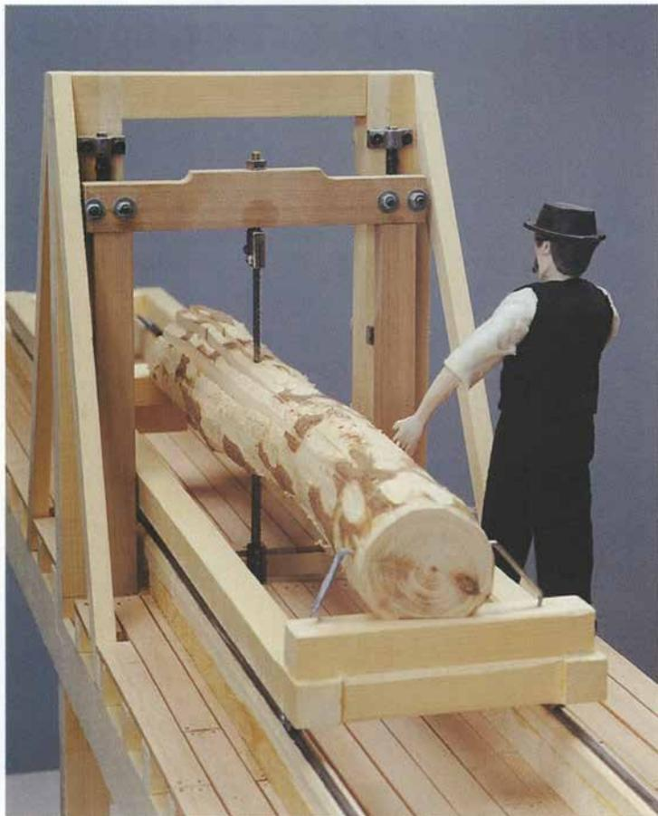
Figure 17. La scie à cadre. La bille, fixée sur un chariot mobile, est amenée face à la lame par un mécanisme d'avance qui s'apparente aux mouvements d'horlogerie. Après déplacement de la bille sur le chariot, la manœuvre peut être répétée pour obtenir des poutres ou des planches. Maquette: H. Lienhard.
